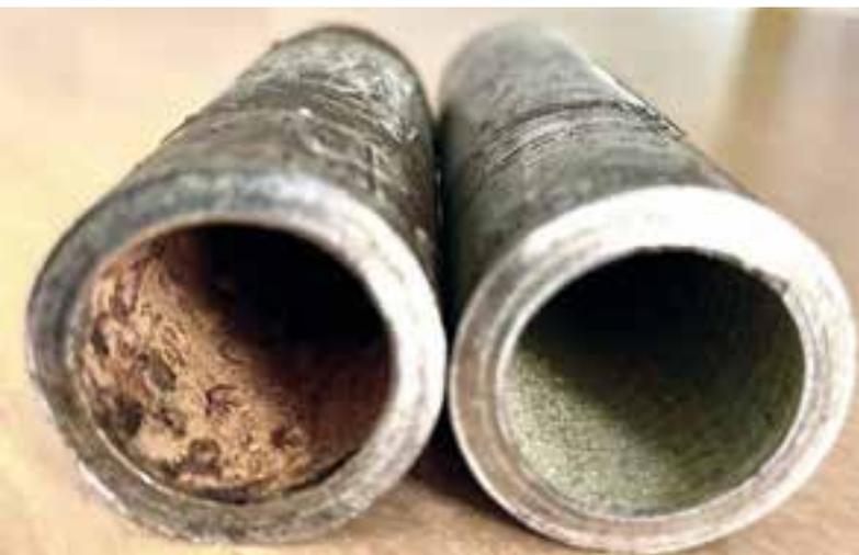
So soll es sein: Blick in Rohrleitungsabschnitte aus einem Bestandsobjekt vor und nach der Behandlung mit Aquabion. Links deutlich erkennbar die Verkrustungen vor Einbau des Systems.
